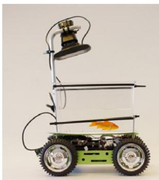
La fishmobile que notre héro utilise pour se déplacer n'est pas un objet tiré d'une œuvre de science-fiction, bien qu'elle y trouverait sa place, il s'agit d'un véhicule bien réel appelé « Fish on Wheels ». Ce dispositif utilise une caméra qui suit les mouvements du poisson et dirige l'aquarium en conséquence.
